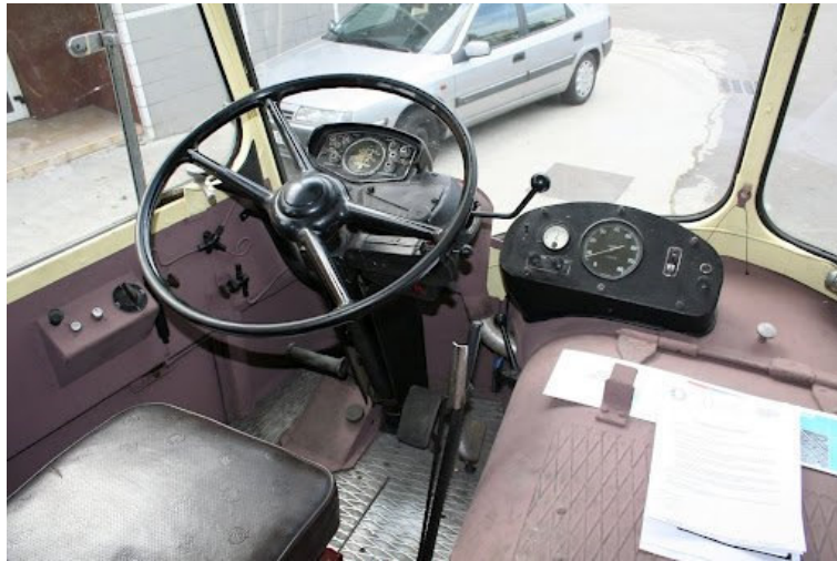
Vue intérieure de l'OP5-2 : le poste du machiniste avec à droite le capot-moteur (content-eu.invisioncic.com)
