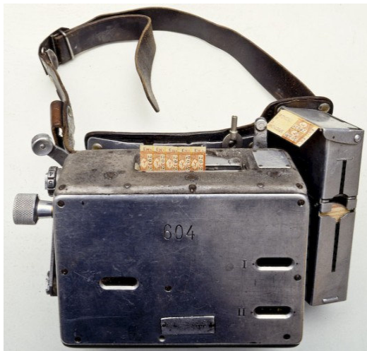
La « moulinette » (oblitérateur de billets) produite par la société CAMP (Construction d'Appareils Mécaniques de Précision) et quelques tickets-lamelles, furent utilisés jusqu'aux années 1970
