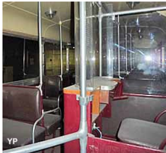
Vues intérieures de l'OP5-2 : banquettes passagers droites (2 passagers) et gauches (1 seul) qui laissent un grand espace aux voyageurs debout et cabine du receveur (doc. Yalta Production) (www.guide-automobiles-anciennes.com)
